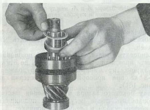
Рис. 160. Установка распорной втулки и регулировочных прокладок подшипника ведущей шестерни
