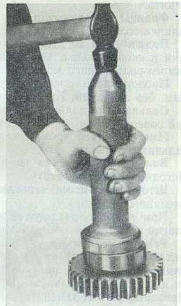
Рис. 120. Напрессовка подшипника на вал привода заднего моста
