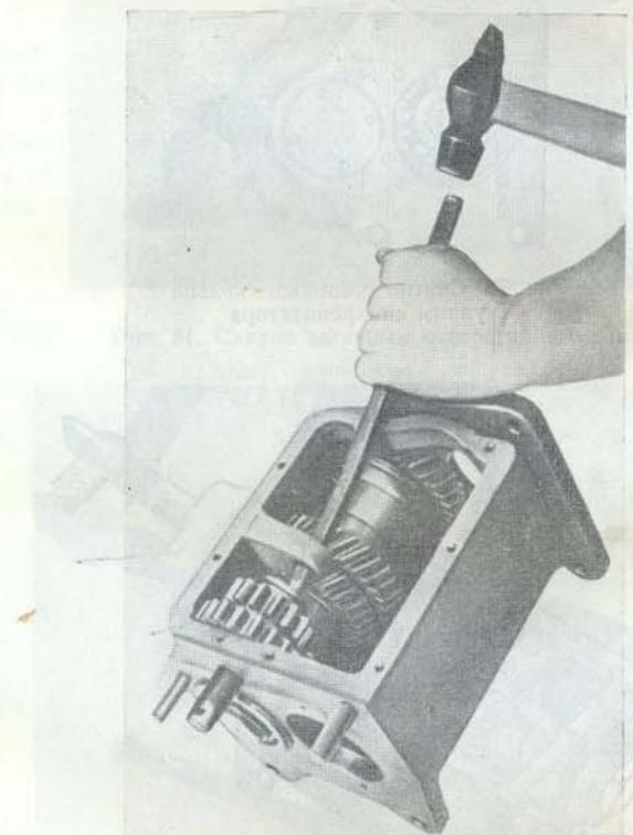
Рис. 77. Снятие блока шестерен заднего хода
