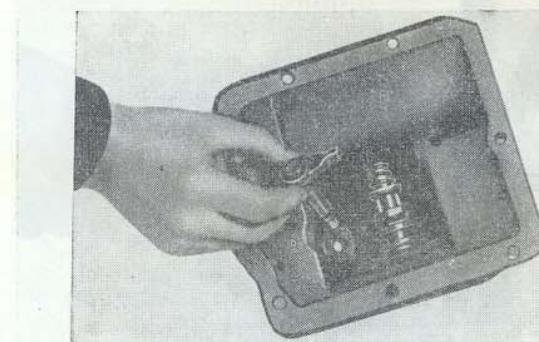
Рис. 104. Установка рычага выбора передач
