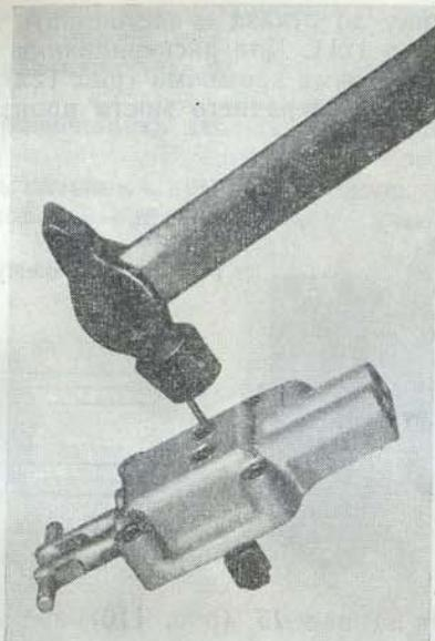
Рис. 124. Установка штифтов в рычаги механизма переключения
