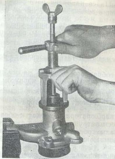
Рис. 62. Снятие ступицы шкива водяного насоса
