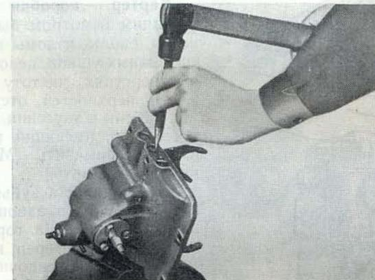
Рис. 81. Снятие заглушек отверстий штоков
