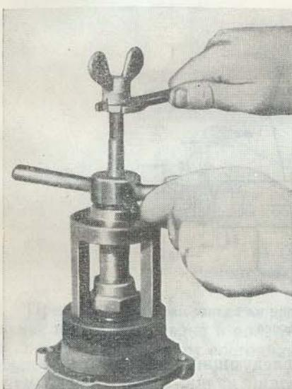
Рис. 61. Снятие крыльчатки водяного насоса
