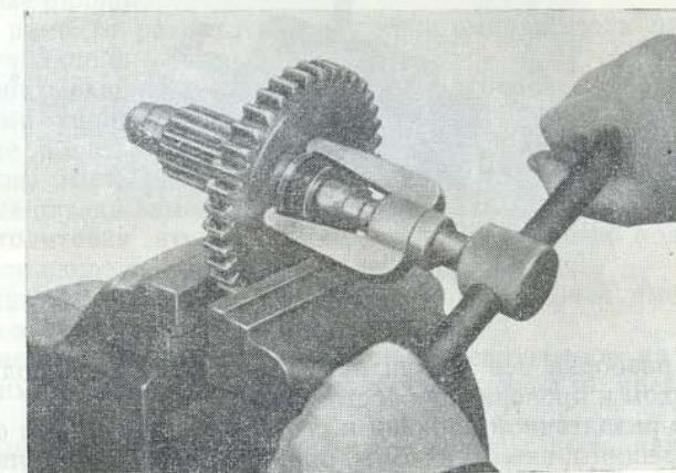
Рис. 117. Снятие кольца роликового подшипника промежуточного вала
