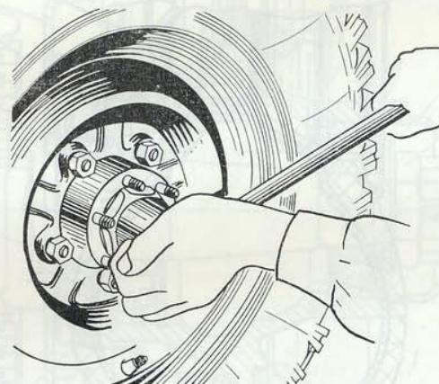
Рис. 187. Регулировка подшипников ступицы
