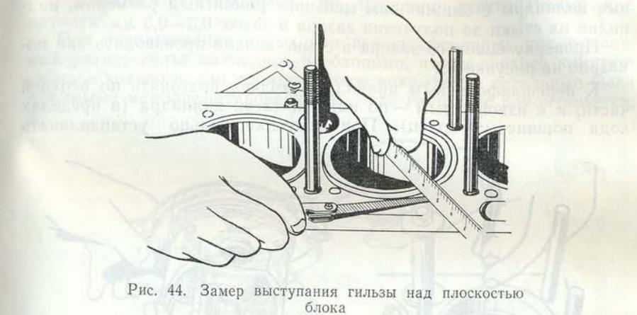
Рис. 44. Замер выступания гильзы над плоскостью блока
