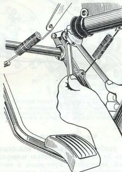
Рис. 216. Регулировка зазора между толкателем и поршнем главного тормозного цилиндра
