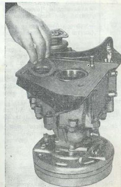
Рис. 137. Раздаточная коробка с пластиной подвески и упорным кольцом подшипника
