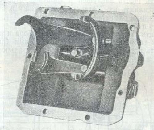
Рис. 107. Закончивание болтов, крепящих вилки, проволокой
