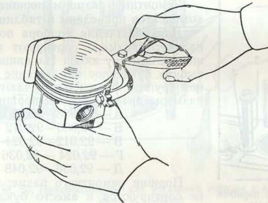
Рис. 48. Очистка канавок поршневых колец от нагара
