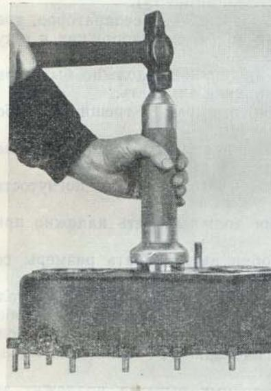
Рис. 119. Запрессовка роликового подшипника в картер
