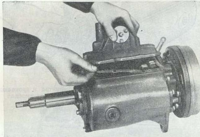
Рис. 101. Установка механизма переключения
