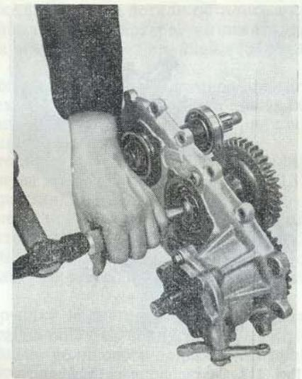
Рис. 115. Снятие валов раздаточной коробки
