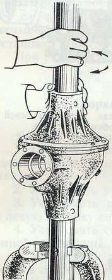
Рис. 156. Прикатка роликов подшипников дифференциала
