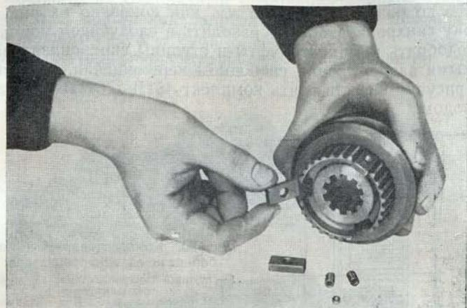
Рис. 91. Сборка синхронизатора
