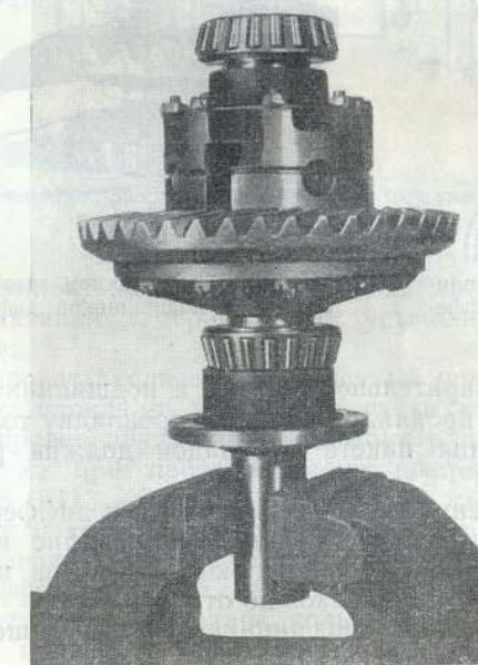
Рис. 155. Недопрессовка внутренних колец подшипников дифференциала
