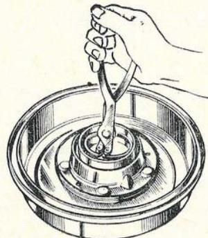
Obr. 70. Sejmout pojistných kroužků ložisek kleštěmi
