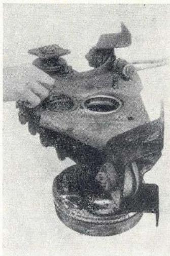
Obr. 59. Přídavná převodovka s deskou, opěrným kroužkem a těsněním
